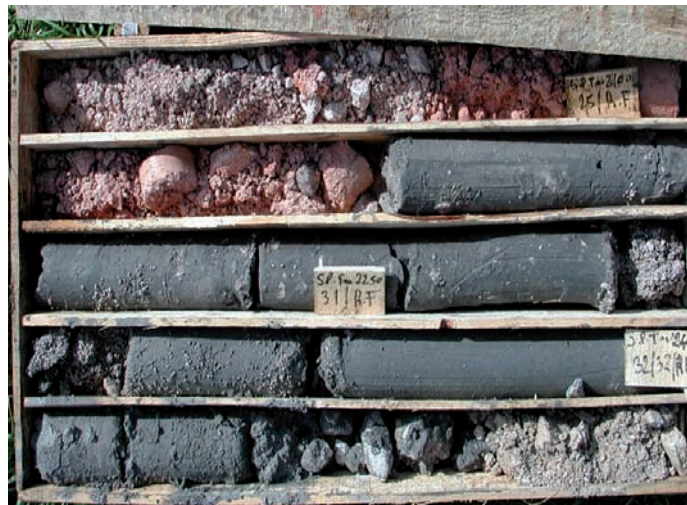
La strisces (Schichten) dl fonz ulache l ie unì giavà per l tunel.
